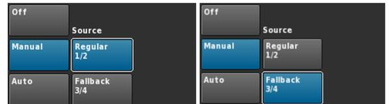
**Auto** 자동 스위치를 설정하려면 Input monitoring («Mon»)이 활성화되고 그에 해당하는 수치를 지정해야 합니다. 원하는 시그널 경로(«Source»)는 로컬 또는 Web Remote 인터페이스 혹은 R1을 이용한 d&b 원격 네트워크를 통하여 수동으로 선택할 수 있습니다.
