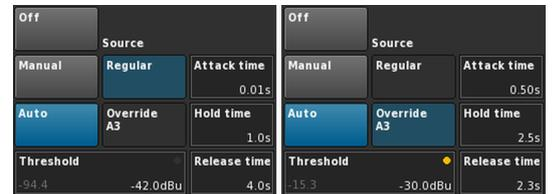
시그널 레벨이 한계점 미만으로 떨어지면 입력 A3이 뮤트로 설정되고 모든 다른 채널은 설정 Hold 및 Release 시간(크로스 페이드)에 따라 뮤트가 해제됩니다.
